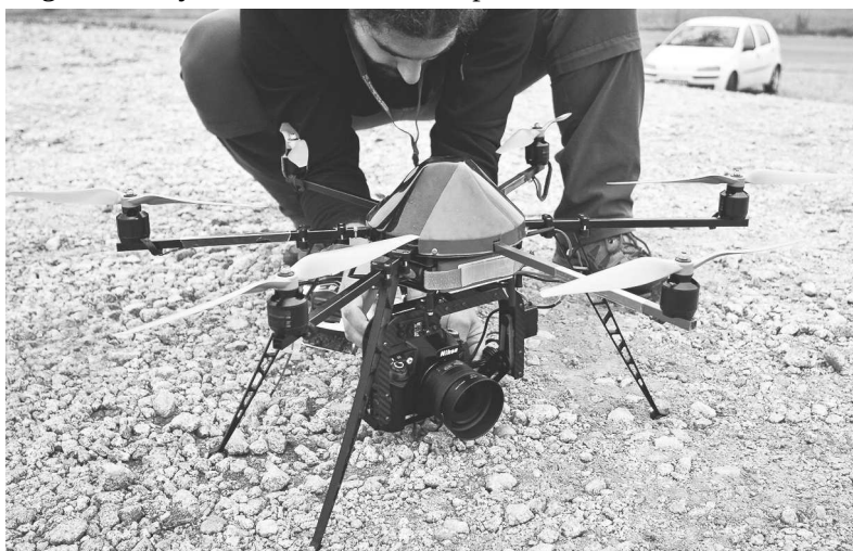
Obr. 1. Príklad mikro-UAV – Hexakopter XL (Mikrokopter HiSystems GmbH)
